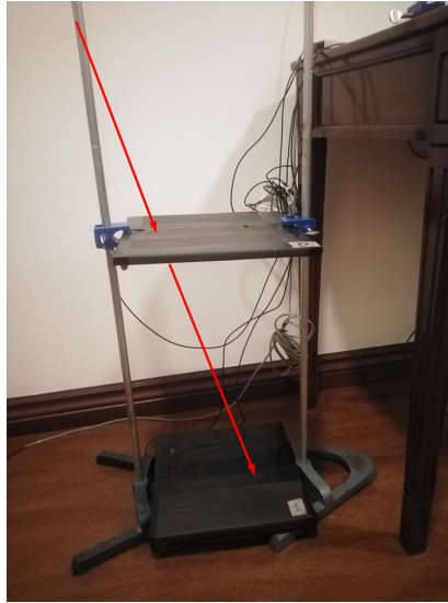
Figura 3: Detector de vida media del muón compuesto por 3 contadores plano paralelos [2].
