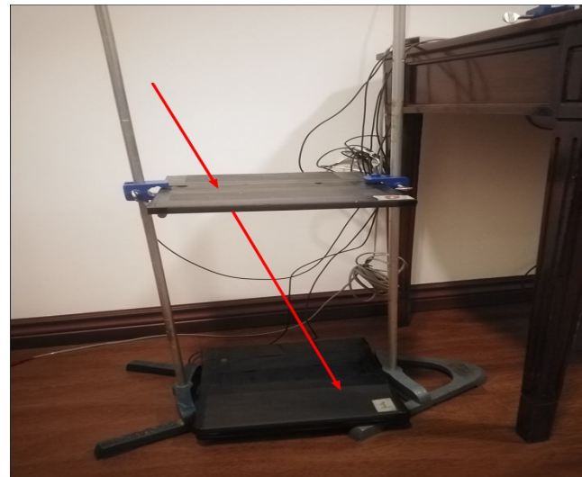
Figura 1: Montaje experimental del telescopio de muones del proyecto Escaramujo
